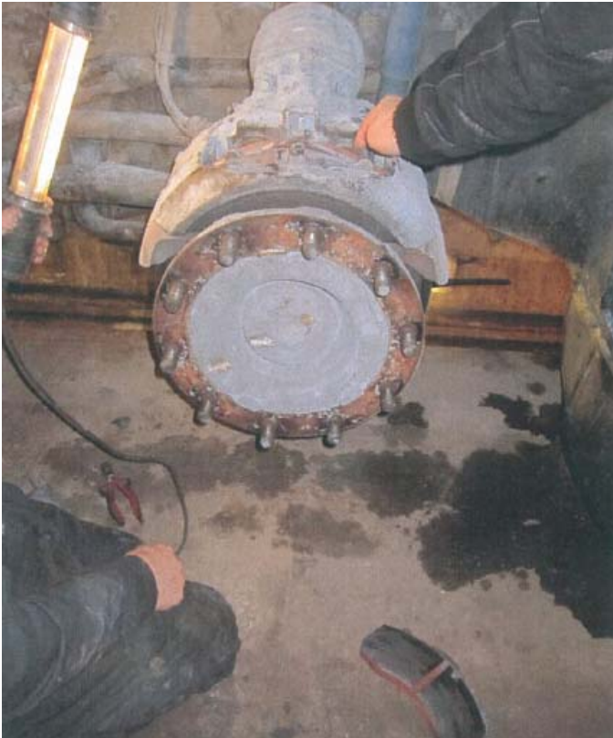
Kuva 2. Ajoneuvon jarrulevyt ja -palat olivat kuumenneet.
