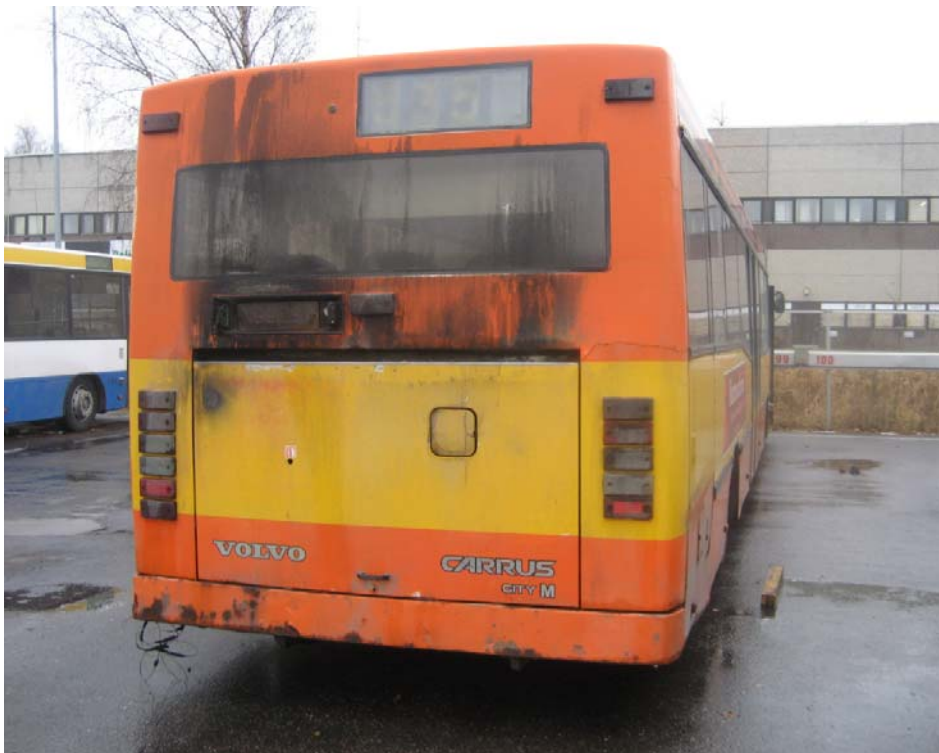
Kuva 10. Palo ei levinnyt moottoritilasta.
