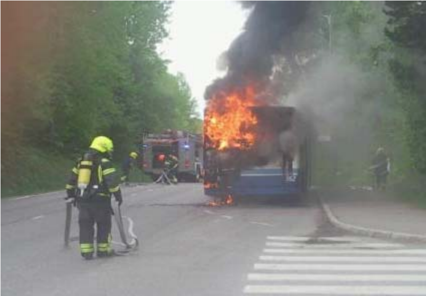
Kuva 5. Ajoneuvon takaosassa oleva moottoritila tulessa.
