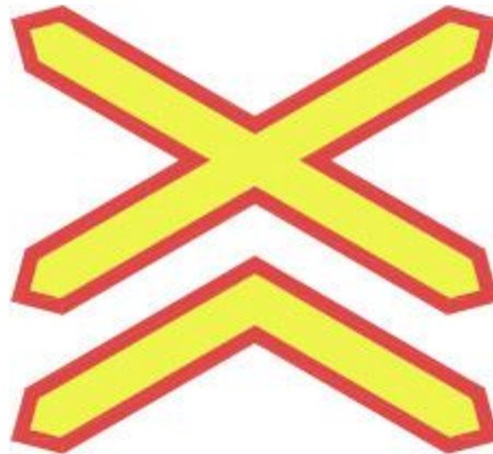
Plankorsning med två- eller flerspårig järnväg
