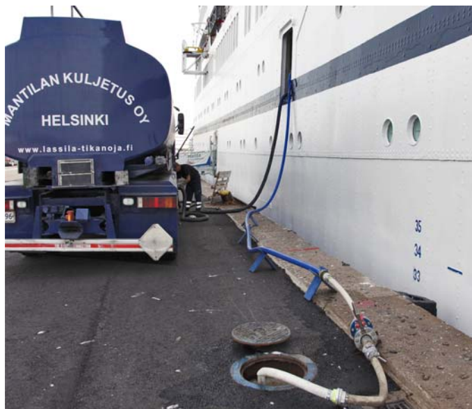
Kuva 4. Jäteöljyn pumppausta laivasta jätehuoltoyritykselle.
